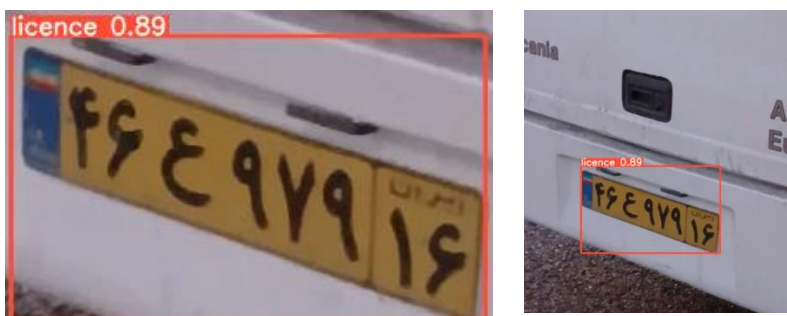
شکل ۳. تصویر پلاک برش خورده پس از مرحله تشخیص ناحیه پلاک، مورد استفاده برای مرحله OCR.
